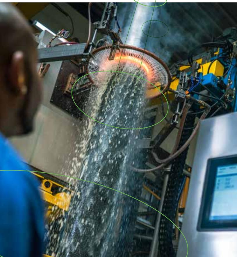
Grazie a un'austenizzazione mirata dello strato superficiale, ossia a una trasformazione della struttura mediante riscaldamento e tempra, aumentiamo la durezza della superficie, mentre il cuore del pezzo preserva la sua plasticità.
